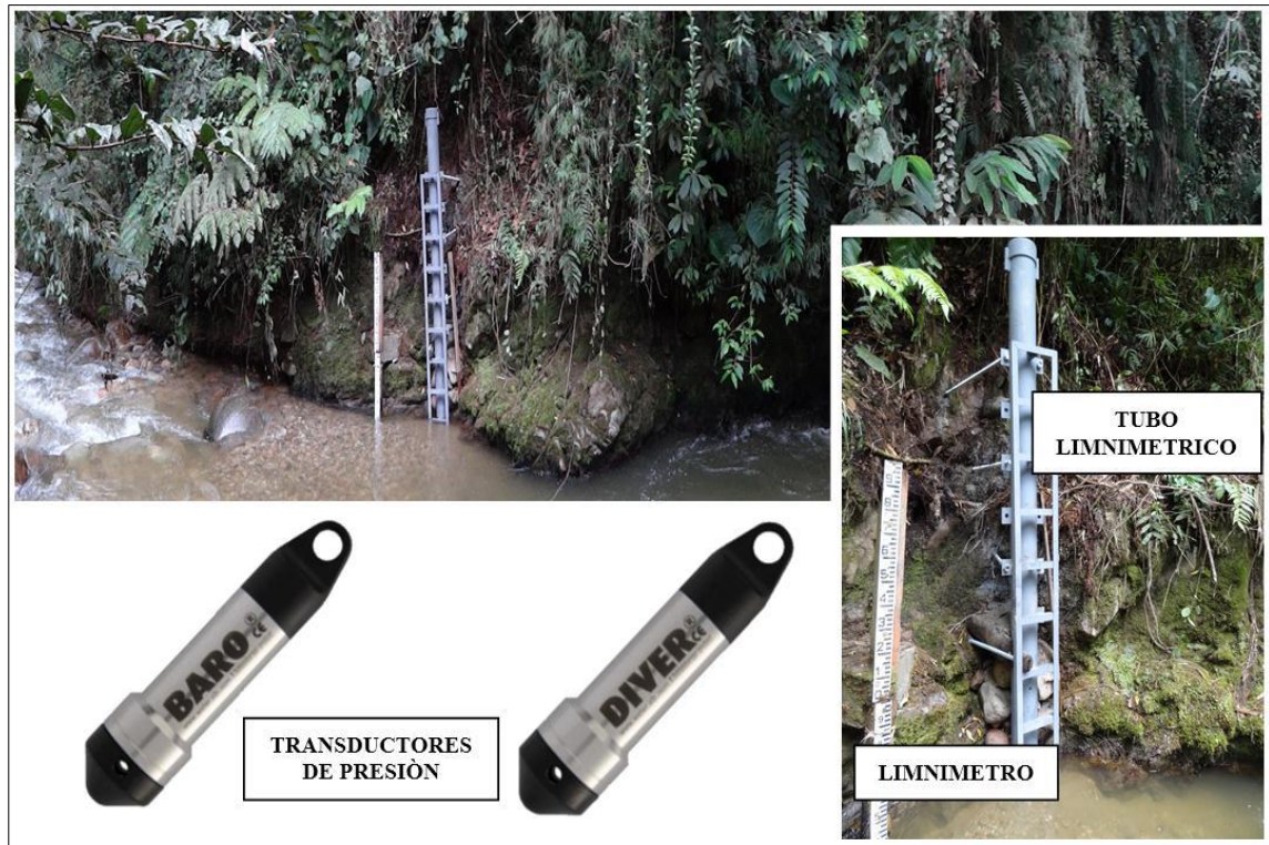
Figura 4. Estación automática de niveles El Rasgón
